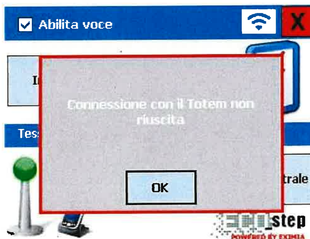
Fig.16 – Connessione con il totem non riuscita, indice di un difetto di configurazione della rete wireless
